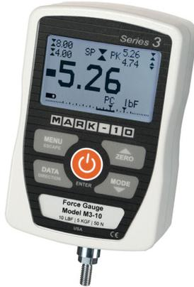
Vielen Dank für den Kauf eines Mark-10 Serie 3 digitales Kraftmessgerät für Zug- und Druckkraft, entwickelt für Prüfanwendungen mit einer Kraft von 0,5 N bis 2.500 N. Das Serie 3 Gerät ist ein wesentlicher Bestandteil eines Kraftprüfsystems, welches in der Regel aus einem Prüfstand, Spannzangen und Datenerfassungssoftware besteht.
