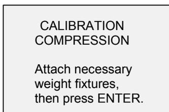
Montieren Sie nach Bedarf Halterungen für die Gewichte (Bügel, Haken, usw.) Bringen Sie noch keine Gewichte an und bringen Sie noch keine Kalibrierlasten auf. Drücken Sie anschließend **ENTER**.
