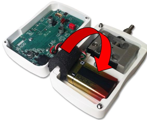
Stellen Sie beim Zusammenbau sicher, dass sich der Schaumstoff über der Batterie befindet. Gehen Sie beim Zusammenbau der beiden Gehäusehälften vorsichtig vor, damit keine internen Kabel beeinträchtigt werden.
