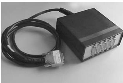
Universalmodul - geeignet für den gleichzeitigen Anschluss von bis zu 5 Kabeln.
