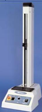
Der MultiTest 1 ist ein preiswerter, über Potentiometer geregelter Prüfstand mit einer Kapazität von 1000 Newton. In Verbindung mit einem MECMESIN Kraftmessgerät und passenden Spannzeugen ist dieses System ideal für unkomplizierte Anwendungen; das Kraftmessgerät erkennt Maximalkräfte in Zug- und Druckrichtung. Der Prüfstand ist auch mit einer Kapazität von 2500 Newton lieferbar.
