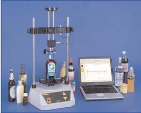
Der neue Vortex-i ist ein komplett rechnergesteuertes motorisiertes Drehmoment-Prüfsystem. Eine hohe Reproduzierbarkeit der Messwerte aufgrund der einstellbaren Geschwindigkeit ist somit gewährleistet. Der Vortex-i ermöglicht die genaue Überwachung des
