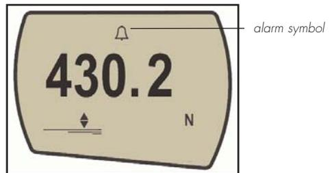
**CONTINUOUS:** Der Summer ertönt bei Erreichen eines vorgegebenen Alarmpunkts und ertönt so lange, bis die Last unter diesen Wert fällt.
