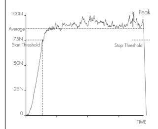
Diese Funktion ermöglicht die Anzeige des Mittelwerts für die Kraft während einer bestimmten Zeit. Die Ermittlung dieses Mittelwerts beginnt, wenn der Schwellenwert (% des Messbereichs) erreicht wurde und endet, wenn die Kraft unter diesen Schwellenwert fällt.
