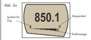
Ein Balken am unteren Rand des Displays gibt dem Betreiber an, wie groß die Last ist, die er auf den Kraftaufnehmer aufgebracht hat. Wenn sich die aufgebrachte Kraft ca. 80% der maximalen Kapazität nähert, ändert sich das Aussehen des Balkens. So wird der Bediener gewarnt, damit er entsprechende Schritte unternimmt, um eine Überlastung zu vermeiden.
