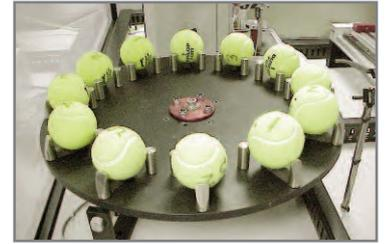
Tennisball-Vorrichtung, auf einem Mecmesin Prüfgerät
