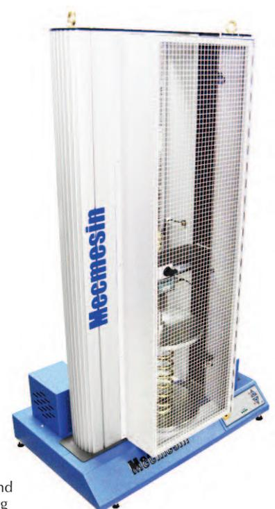
Zweisäuliger Prüfstand mit Schutzvorrichtung
