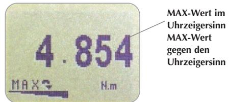
Wenn Sie dann abermals die **MAX**-Taste drücken, wird das größte während der Messung aufgetretene Drehmoment entgegen dem Uhrzeigersinn zusammen mit dem entsprechenden Symbol angezeigt.
