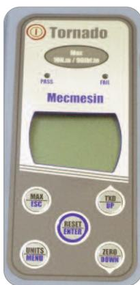
Um das Gerät einzuschalten, drücken Sie die rote
