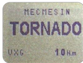
Nach dem Selbsttest wird - vorausgesetzt, dass kein Drehmoment aufgebracht wird - im Display Null angezeigt, da sich TORNADO während des Selbsttests auf Null zurückstellt.
